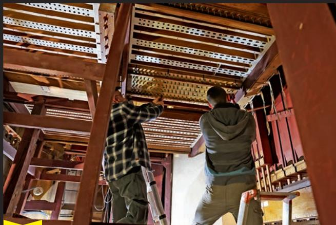
*Le sommier, dispositif qui distribue l'air sous pression aux tuyaux, en cours de remontage. Quatre facteurs d'orgues sont intervenus dans « le ventre » de l'instrument. À mesure que les éléments qui le composent sont remis en place, l'espace devient étroit !*
