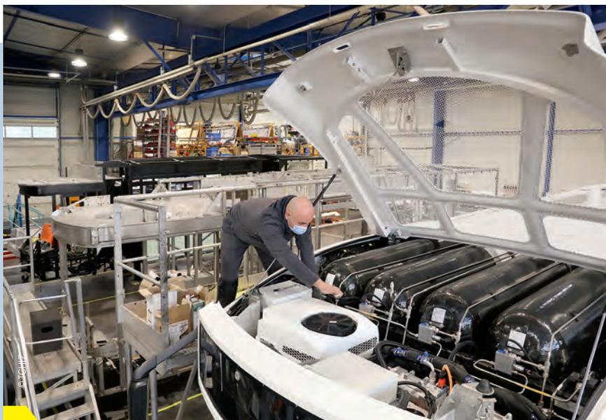
Les réservoirs d'hydrogène au-dessus d'un Businova H2.
