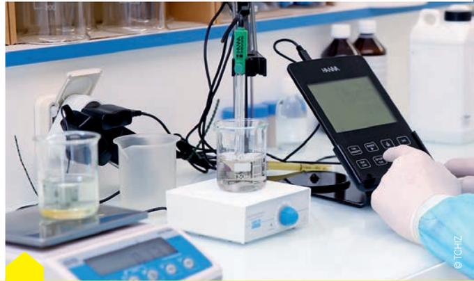
Le laboratoire d'analyse qui surplombe les bassins de traitement assurera le contrôle en continue de plusieurs paramètres (turbidité, pH, taux de chlore, etc). Les agents pourront également effectuer des analyses plus précises.
